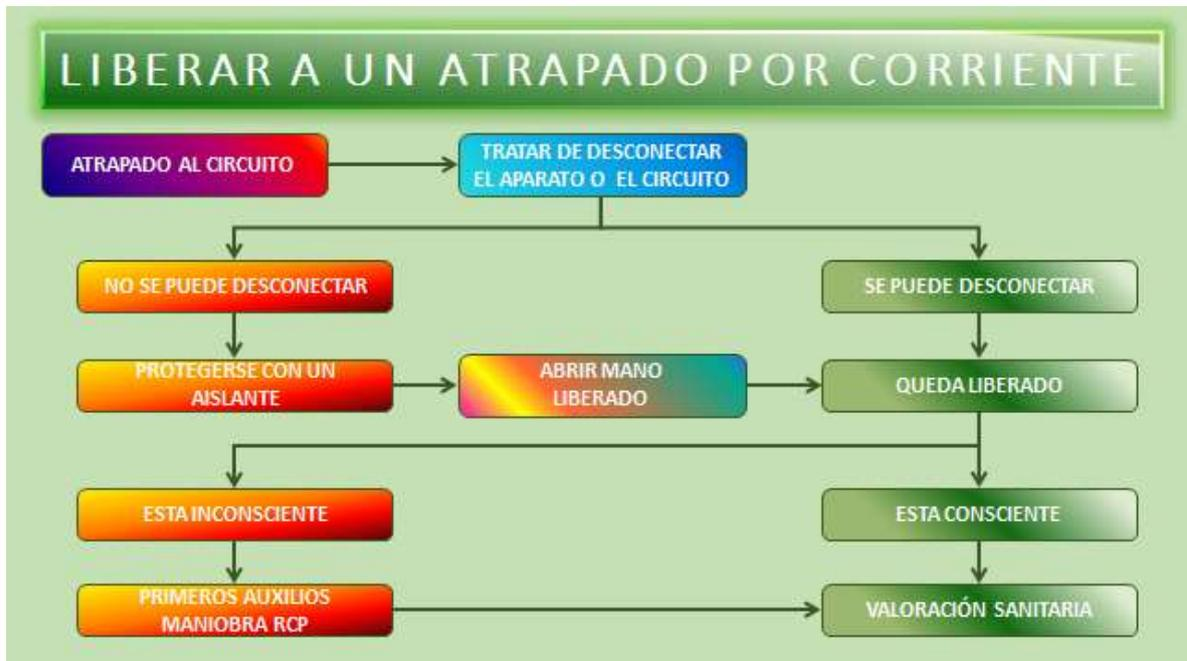
Ilustración 16. Esquema de liberación de atrapado por corriente eléctrica
