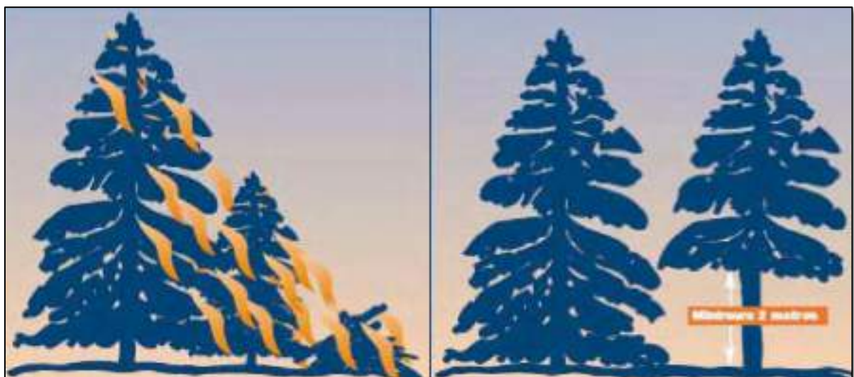
Fig. 100: Reducción de la continuidad vertical del combustible mediante podas por lo bajo (elaboración Tecnomia para la Generalitat Valenciana)
