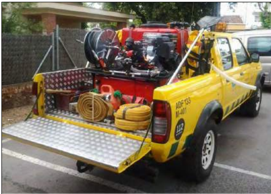
Fig. 110: Pick-up con depósito de agua, motobomba de alta presión, mangueras y demás herramientas de extinción (fotografía Hispamast)
