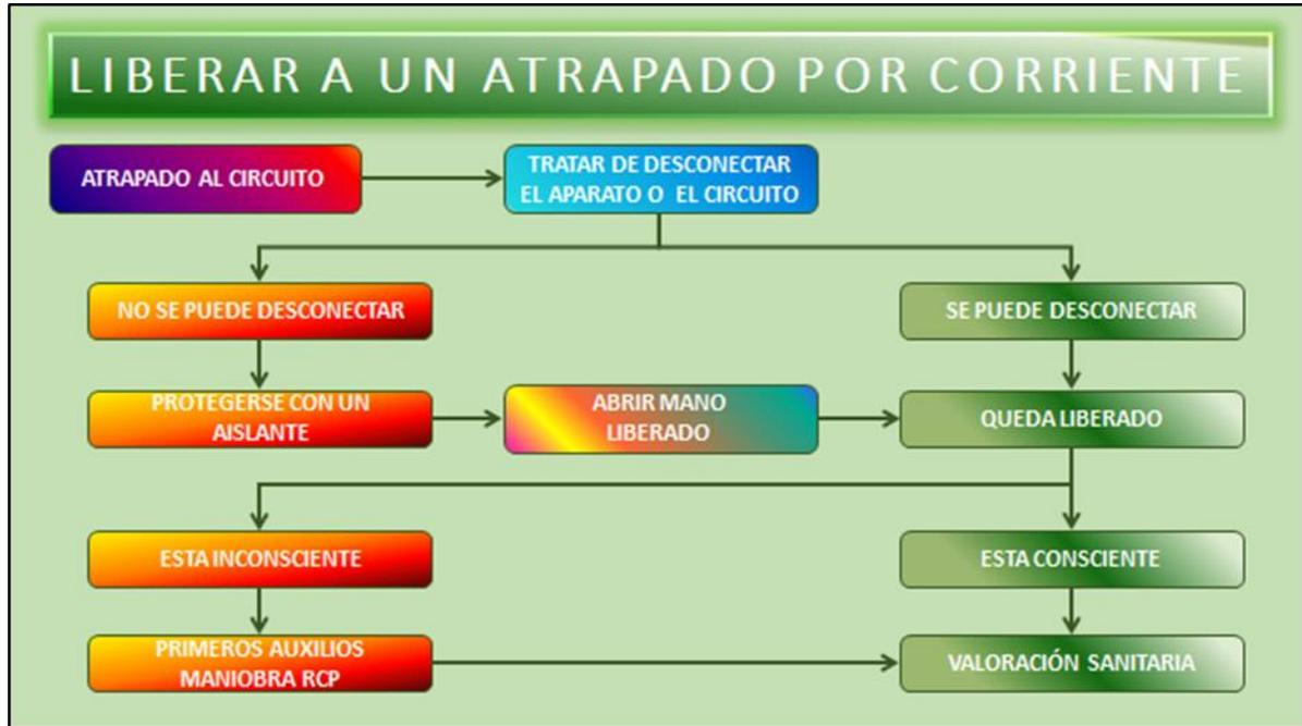
Ilustración 20. Esquema de liberación de atrapado por corriente eléctrica
